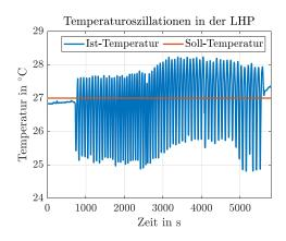
LHP-Regelung berücksichtigt werden. Die Modellierung und Regelung dieses komplexen, nichtlinearen Wärmetransportsystems ist Gegenstand aktueller Forschungen. Durch die Transportprozesse in der LHP und die damit verbundenen Verzögerungszeiten entstehen unerwünschte Temperaturoszillationen. Durch den Entwurf entsprechender modellbasierter Regelungen sollen diese Temperaturoszillationen kompensiert werden.
