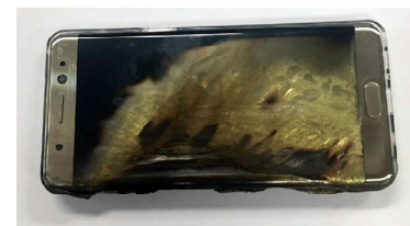
Abb. 1: Auswirkung einer defekten LI-Batterie
