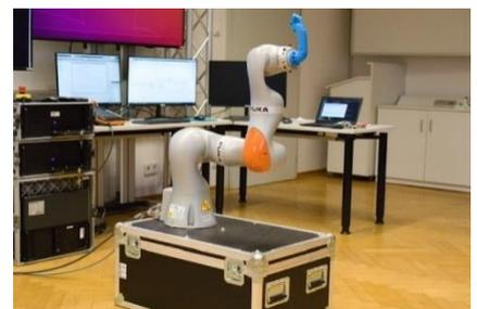
KUKA-Roboterarm als HMI
